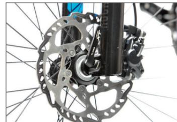
Ein Mehrschicht-Aufbau (ICE-Tech) kühlt die Bremsscheibe effektiv
