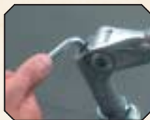
Ajustement de l'hauteur de guidon
