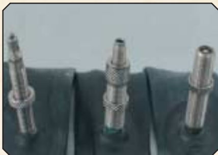
Fietsventielen (van links): Schlaverant - of Frans ventiel Dunlop - ventiel Schrader - of autoventiel
