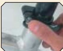
Ouverture / fermeture du blocage rapide de la tige de selle
