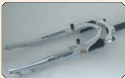
Verende voorvork met instelling van de voorspanning
