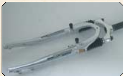
Vorderradgabel gefedert mit Einstellung der Vorspannung
