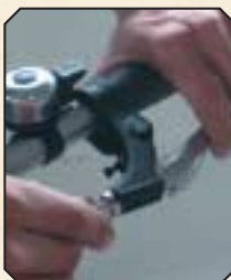
Greepwijdte van de remhendel Functiecontrole van de rem
