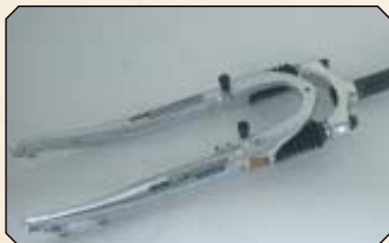
Fourche suspendue avec pré-contrainte
