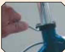
Öffnen / Schließen einer Sattelklemmschraube
