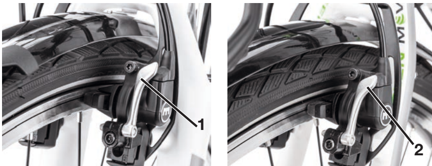
Abbildung 28: Schnellspannhebel der betriebsbereiten Felgenbremse
