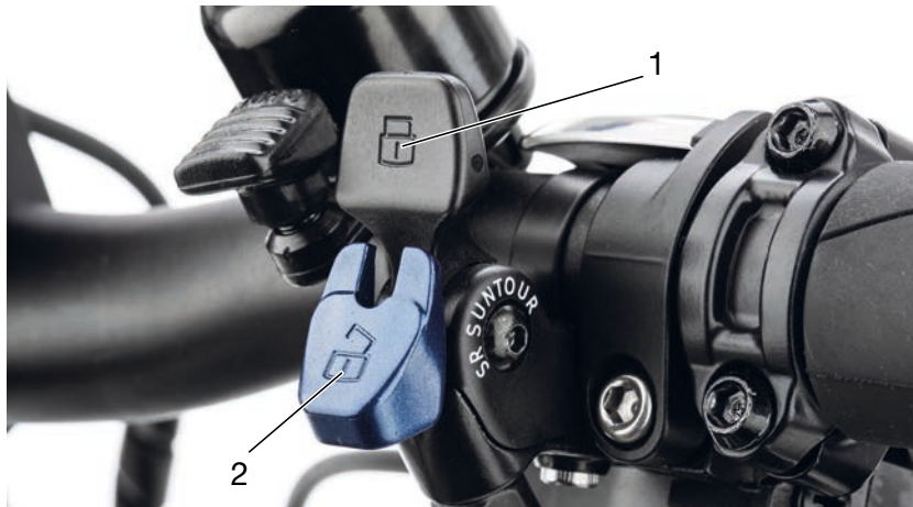
Abbildung 16: Gabelsperre, Ausführung IV
