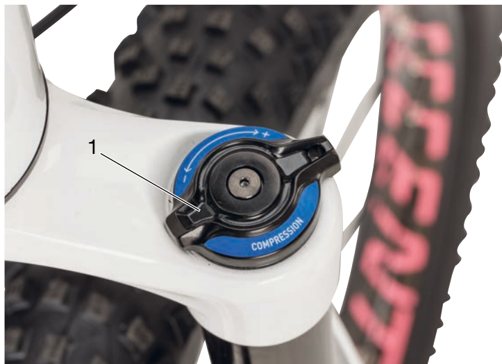
Abbildung 14: Gabelsperre, Ausführung II (Beispiel)
