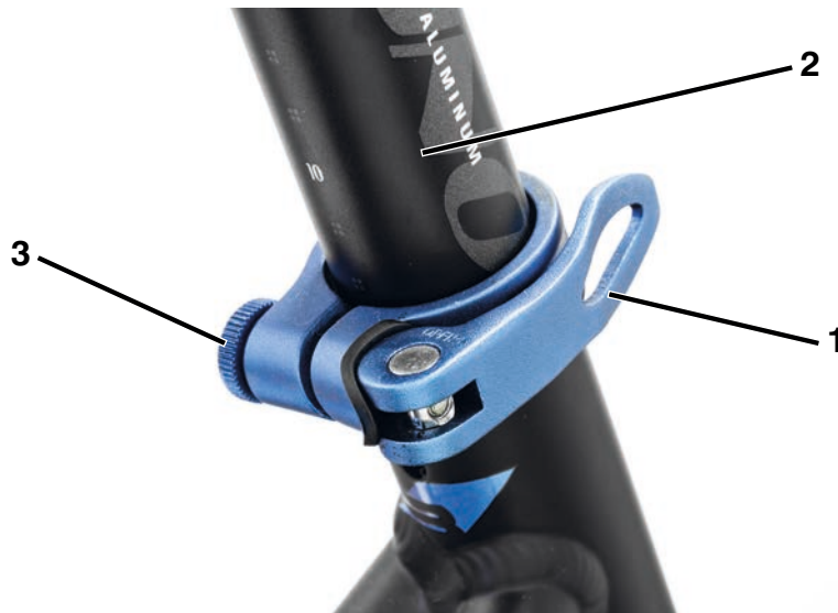
Abbildung 7: Schnellspanner der Sattelstütze, geschlossen
