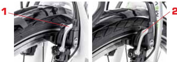
1 Schnellspannhebel vorne      2 Schnellspannhebel hinten
