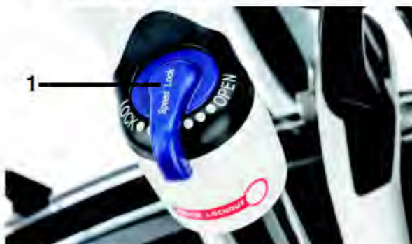
Abbildung 14: Gabelsperre, Ausführung I (Beispiel)
