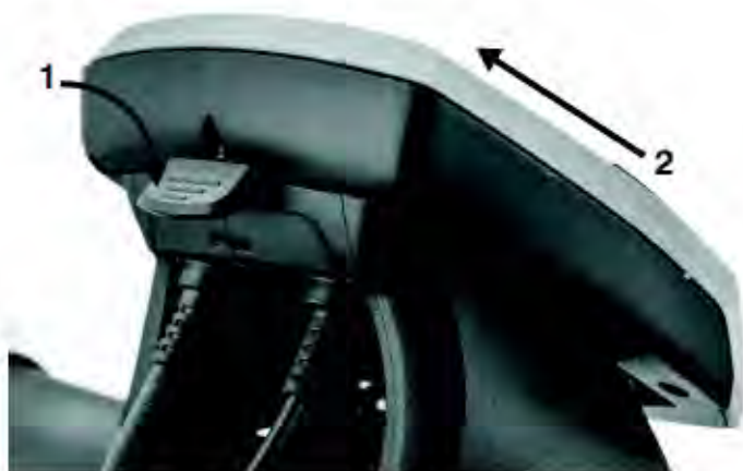
Abbildung 39: Abnehmen des Bildschirms
