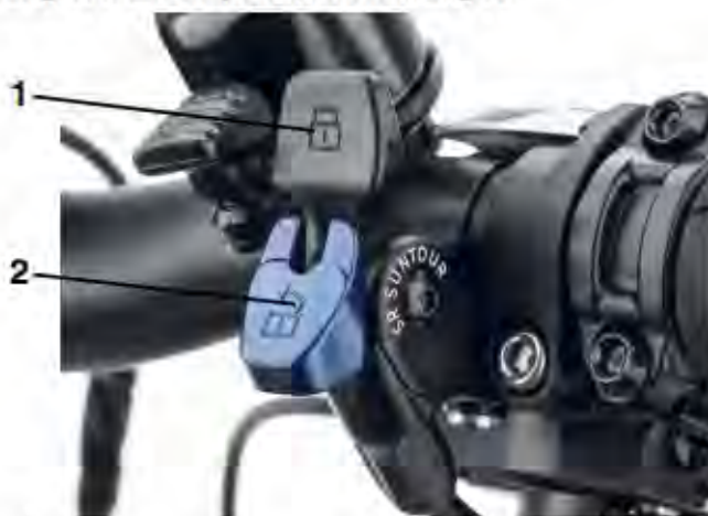
Abbildung 17: Gabelsperre, Ausführung IV
