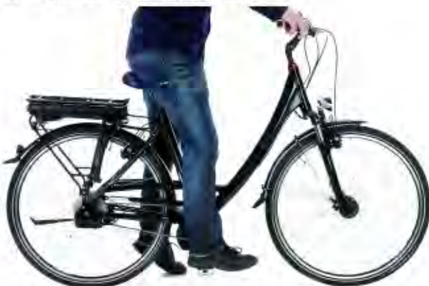
Abbildung 9: Ermittlung der Sattelhöhe
