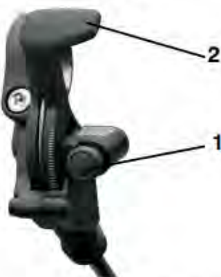
Abbildung 19: Gabelsperre, Ausführung VI
