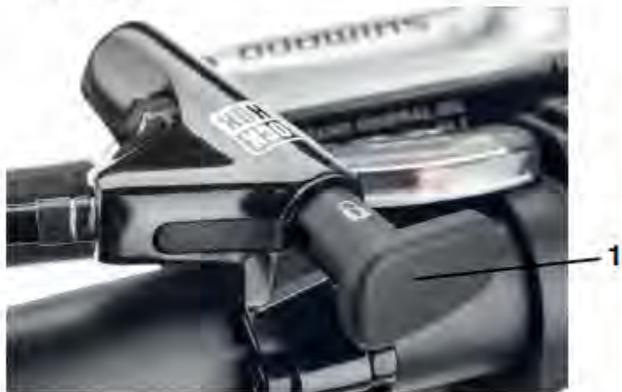
Abbildung 16: Herausgeschobener Sperrschieber am Lenker (Beispiel)
