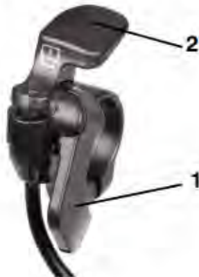
Abbildung 20: Gabelsperre, Ausführung VII
