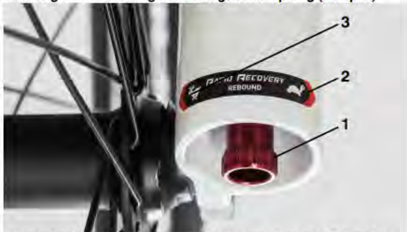
Abbildung 21: Einstellung der Federgabeldämpfung (Beispiel)
