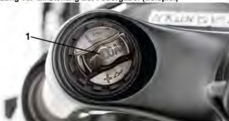
Abbildung 12: Einstellung der Federgabel (Beispiel)
