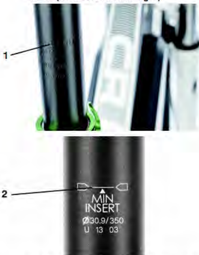
Abbildung 10: Markierungen der Mindesteinstecktiefe der Sattelstütze (alternative Ausführungen)
