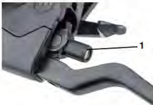
Abbildung 30: Einstellung der hydraulisch betätigten Felgenbremse (Beispiel)
