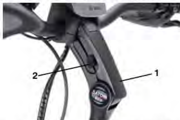
Abbildung 7: Lenkereinstellung bei werkzeuglosem Vorbau
