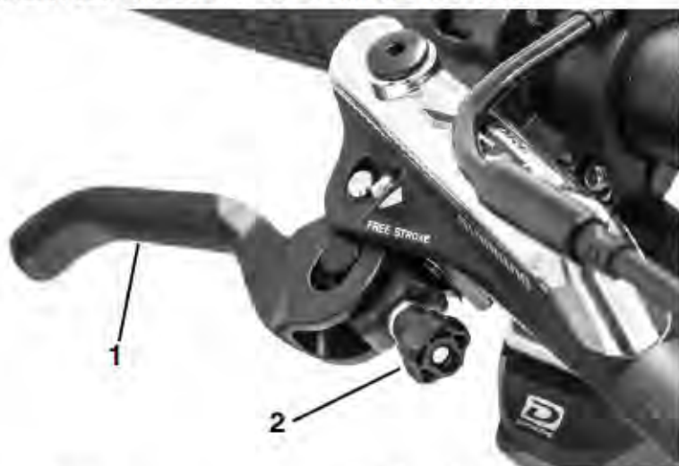
Abbildung 32: Einstellung der Greifweite (Beispiel)
