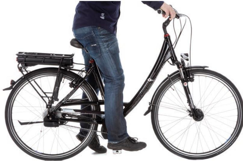
Die Sattelstütze darf nicht über die Markierung zur Mindesteinstecktiefe aus dem Rahmen gezogen werden.
