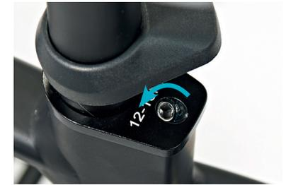
zu 1. Sattelschraube(n) lösen
