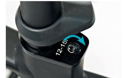
zu 3. Sattelschraube(n) festziehen
