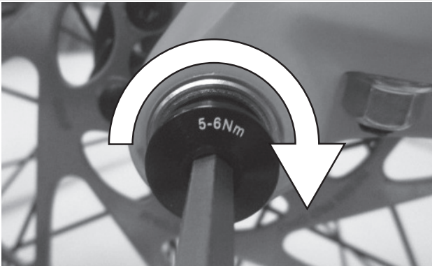
Abbildung 30: Sicherungsschraube anziehen
