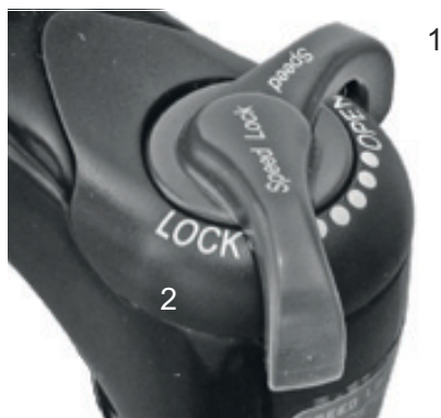
Abbildung 75: Suntour-Druckstufen-Einsteller mit den Positionen OPEN (1) und LOCK (2)
