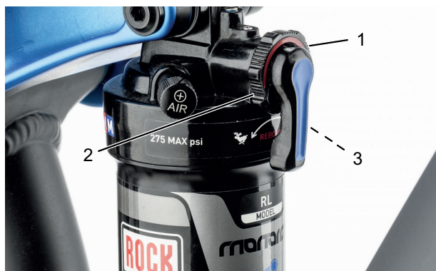
Abbildung 81: Härte des Zugstufen-Dämpfers am Einstellrad (1) des Hinterbau-Dämpfer einstellen
